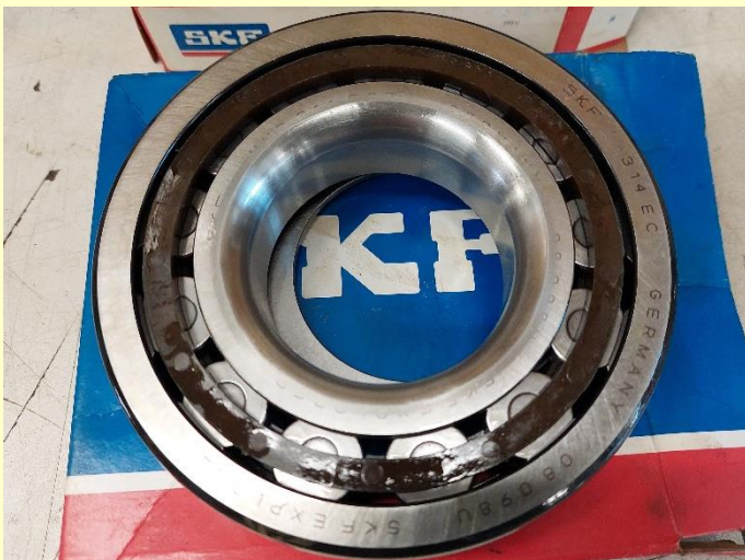
Sogar fabriksneue Originallager mussten extra überarbeitet werden; im Fall der zwei Kurbelwellenlager hat unser Partner Krüger-Metaltechnik aus Rabenstein (NÖ) die Radien an die der JW-Kurbelwelle angepasst
