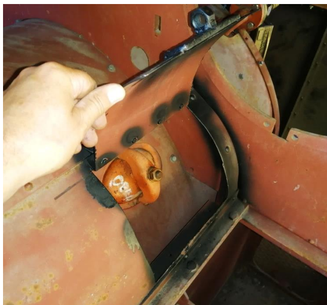
Jetzt geht es viel leichter. Die Waschlücke ist nun durch die geöffnete Wartungsklappe einfach und bequem zu erreichen. Foto: M. Eibl
