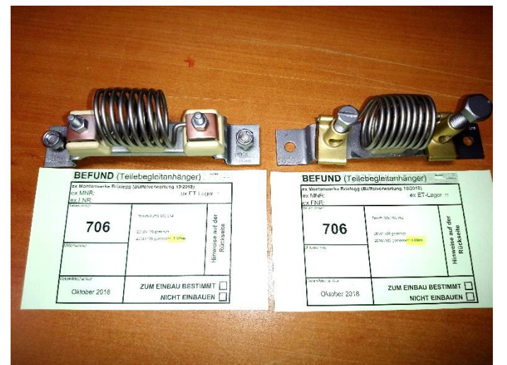
Nach der Reinigung wurden unterschiedliche Widerstandswerte ermittelt
