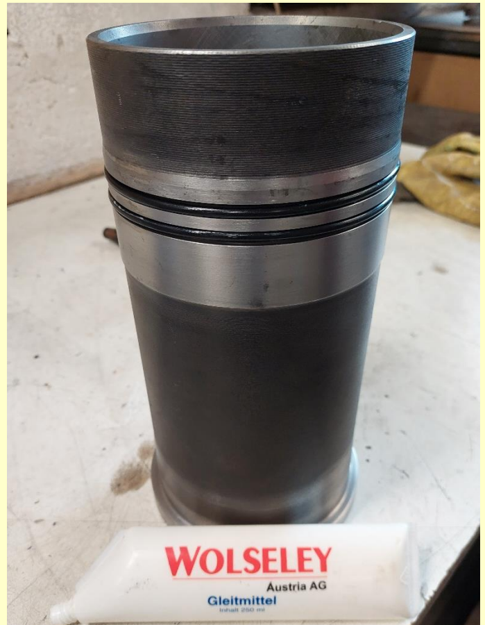
Die etwa 60 Jahre alte, aber fabriksneue Jenbacher-Laufbüchse aus unserem Kanada-Ersatzteillager ist fertig zum Einbau in den Elba-Motor
