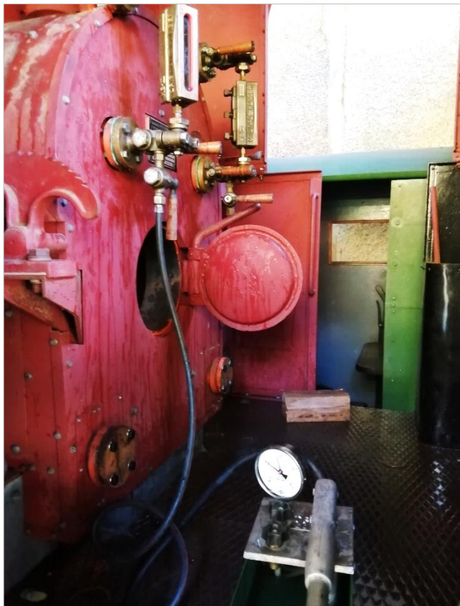
Die Wasserdruckprobe ist eine spannende Sache. Mit der Handpumpe wird Wasser über den linken Klinger-Wasserstand in den Kessel gedrückt. Das Manometer zeigt den Druck an. Foto: M. Eibl
