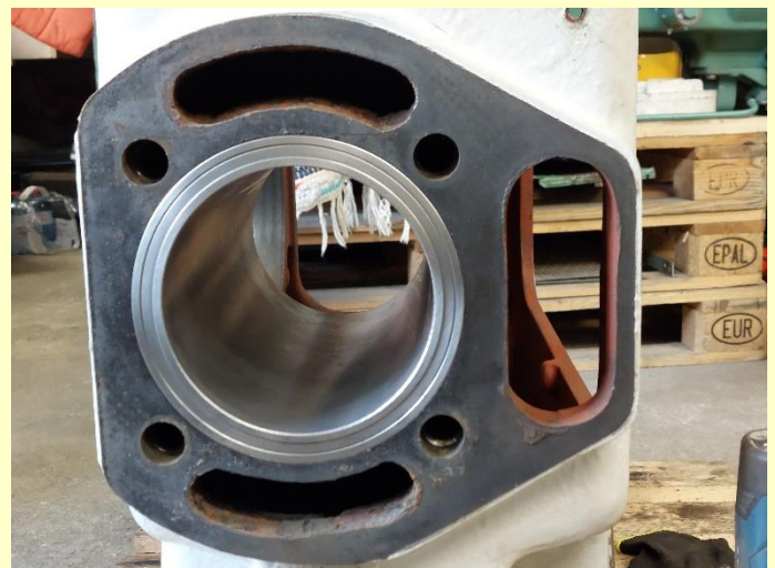
Die neue Laufbüchse fertig montiert – eine Freude und Motivation nach den vielen Reinigungs-, Reparatur- und Aufarbeitungsstunden des völlig desolaten Motorblocks
