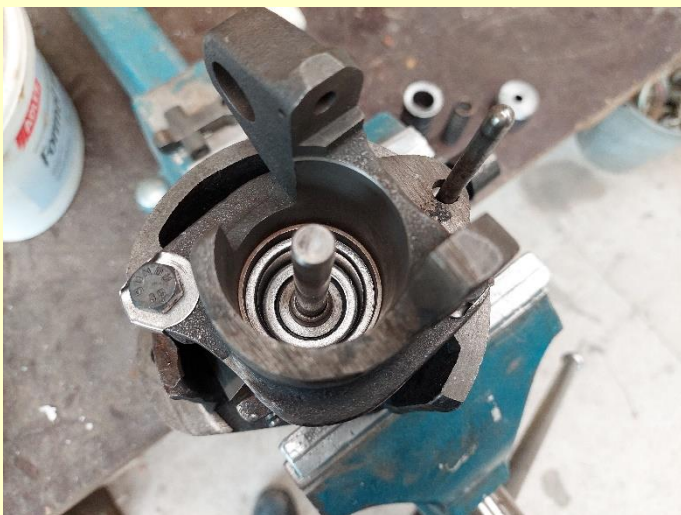
Der Regler nach dem Überarbeiten der Einzelteile beim Zusammenbau
