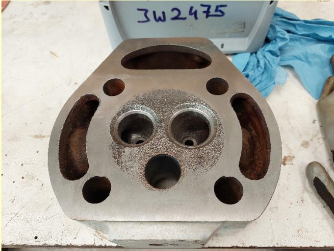
Zylinderkopf: geschliffen, Ventilsitze gefräst und neue Ventilführungen
