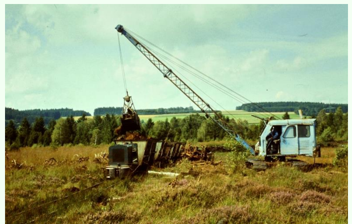
Seilbagger Typ Weserhütte Pionier 1987 beim Laden des Torfzugs
