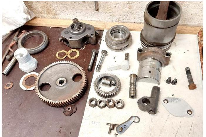
Alle Einzelteile des Motors werden gereinigt, beurteilt und aufgearbeitet
