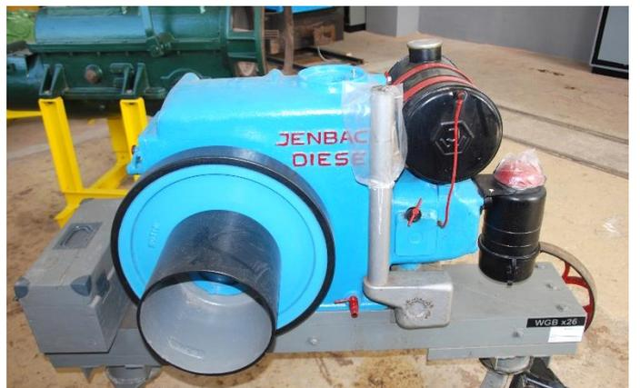
Der Standmotor mit Riemenscheibe vor dem Umbau in einen Pony-Lokmotor
