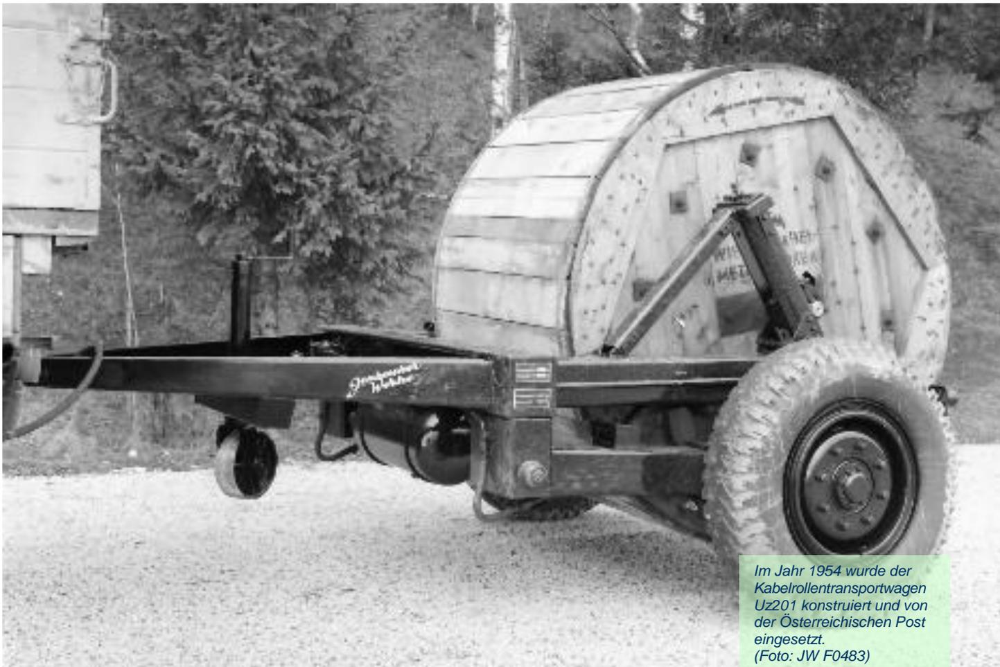
Im Jahr 1954 wurde der Kabelrollentransportwagen Uz201 konstruiert und von der Österreichischen Post eingesetzt.
