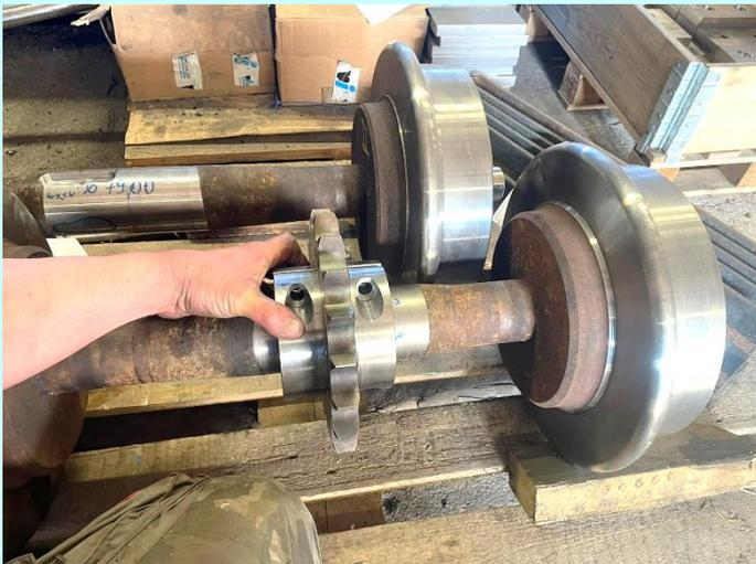
Neues Kettenrad wird erstmals zur Probe auf die überdrehte Achse gesetzt
