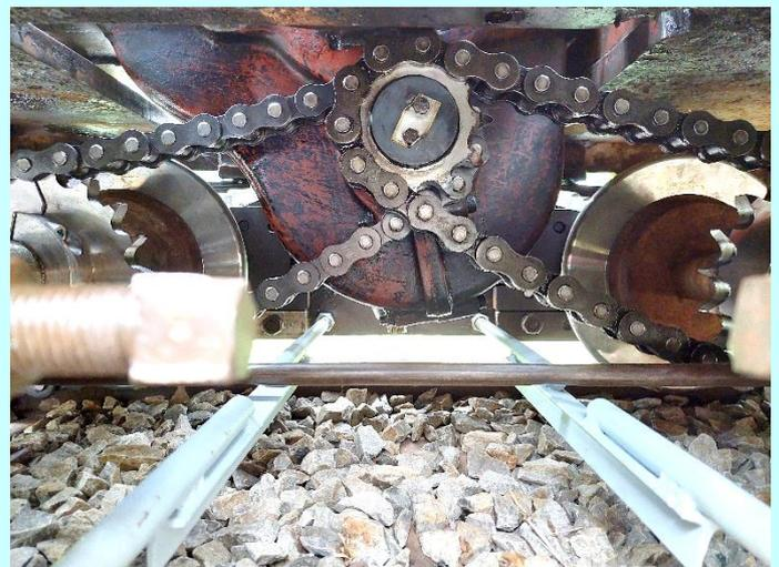
Neue Antriebsketten; in der Mitte das neue Getriebe-Doppelritzel, links und rechts geteilte Achskettenräder und unten neue modifizierte Zuganker
