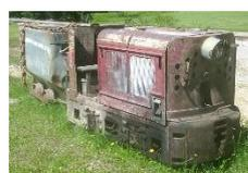
Ein JW20-Motor aus einem Sägewerk wird in einen Lokmotor für unsere **JW20 FNR 2557** (WGB 52) umgebaut. Im Zuge der Arbeiten wird das von den Jenbacher Werken vorgegebene 1600-Std.-Service gemacht.
