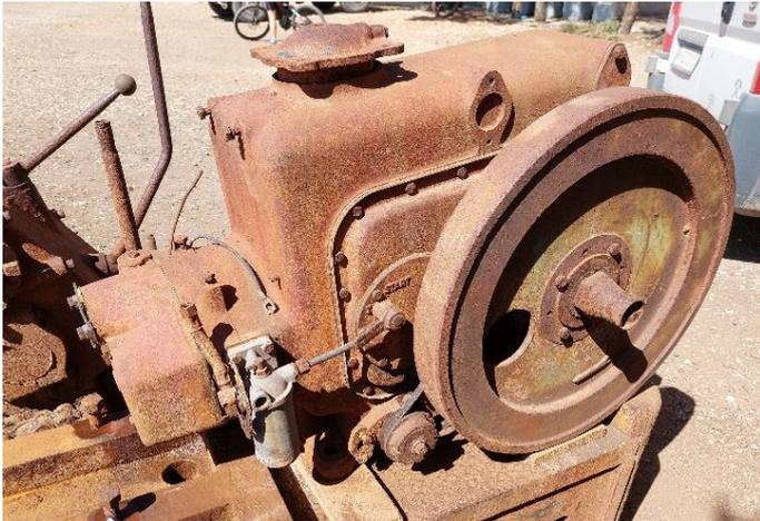
Defekte: gebrochene Start-Stopp-Welle, Reglereingriff, Wasserschlag, etc.
