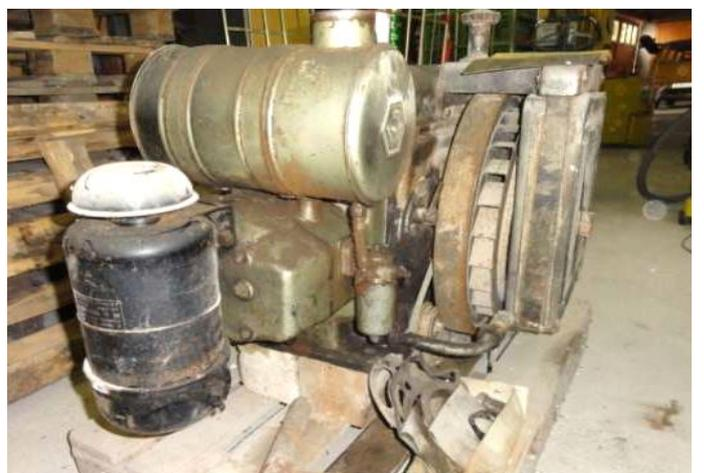
JW20-Standmotor: Umbau auf Lokmotor für Lok FNR 2557 (WGB 52) ■
