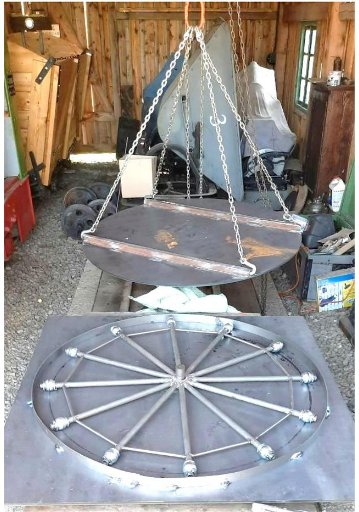
Entladen der gelaserten Teile und erste Funktionsprobe: die „Schienen“ auf der Scheibe entstanden aus alten Hängebahnschienen eines Heuaufzugs
