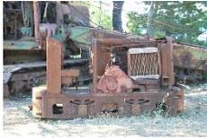
Der Motor der Grubenlokomotive **JW20 FNR 2475** ist in Niederösterreich gereinigt, gestrahlt und lackiert worden, bevor er nun in Schwaz/Tirol komplett zerlegt und repariert wird.
