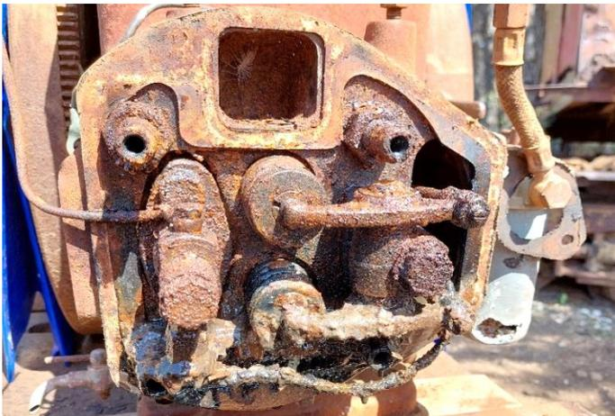
Wasser im Kurbelraum hinterlässt seine Spuren auch am Zylinderkopf
